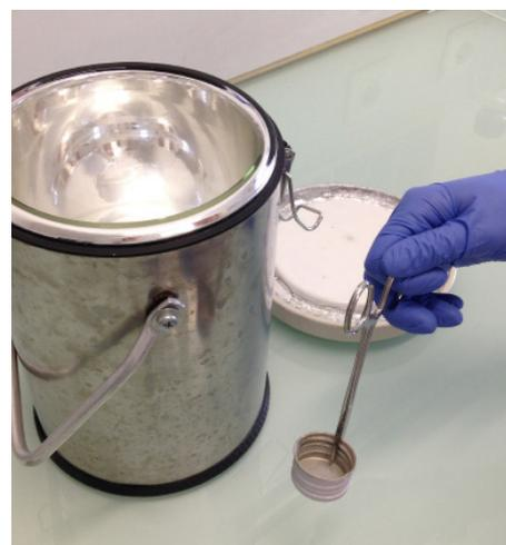
Matériel utilisé pour la fixation par le froid
