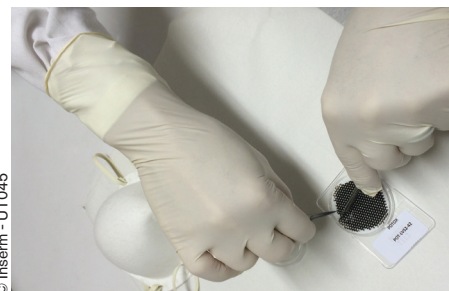
Récupération des particules de la pollution atmosphérique à partir de filtres.
